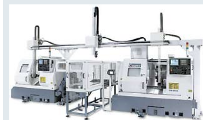
■ Рис. 7. Роботизированные погрузочно-разгрузочные системы позволяют объединить несколько станков в комплекс для механической обработки деталей
